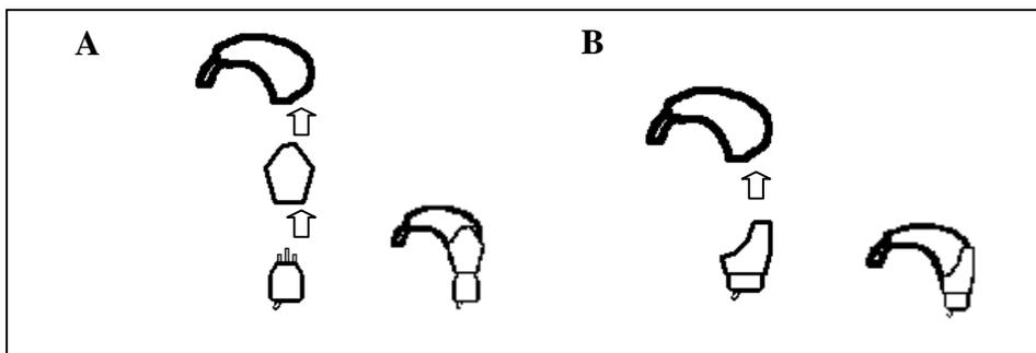
圖 5-7 接收器透過音靴與助聽器無線連結的方式：(A) 助聽器 + 音靴 + 插座式接收器；(B) 助聽器 + 音靴 / 插座式接收器
