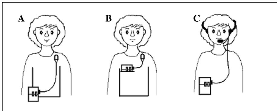
圖 5-3 發射器與麥克風有線連結：前兩個圖片麥克風都夾在領子上，稱做夾領式麥克風。(A) 發射器掛在腰間；(B) 發射器放在口袋裡；(C) 麥克風戴在頭上，又稱播報員式麥克風。
