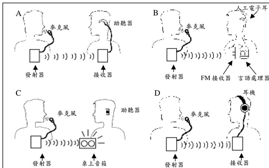
圖 5-1 調頻輔具的使用示意圖：說話者將聲音訊號傳入與發射器相連的麥克風，接著發射器以無線電波的形式，將訊號傳遞至接收器，然後接收器將訊號傳至 (A) 助聽器；(B) 電子耳蝸；(C) 桌上音箱；(D) 耳機，最後聽取者聽到聲音。
