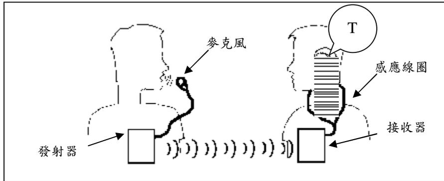
圖 5-8 接收器透過感應線圈送出的電磁波以電流感應方式傳給助聽器的電話線圈
