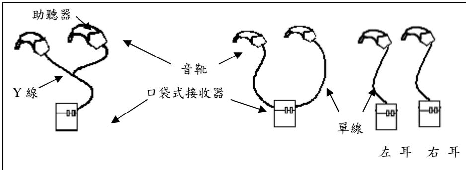
圖 5-6 助聽器透過音靴與接收器有線連結的方式
