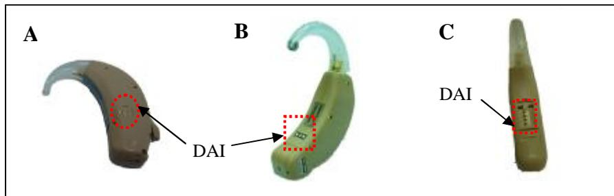
圖 5-4 DAI 的型式依廠牌及機型而有不同：(A) (B) DAI 外顯在助聽器上；(C) DAI 隱藏在助聽器的機體裡，需將蓋子挑開才看得到
