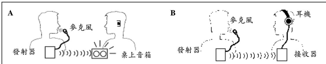
圖 5-9 助聽器無 DAI 也無 T 的裝置時，與 FM 的連結方式：(A) 使用桌上型調頻輔具；(B) 使用耳機型調頻輔具
