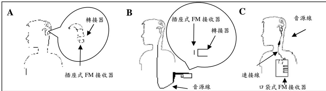
圖 5-10 耳掛式電子耳蝸與接收器的連結方式：(A) 無線連結（插座式接收器）；(B) 有線連結（插座式接收器）(C) 有線連結（口袋式接收器）
