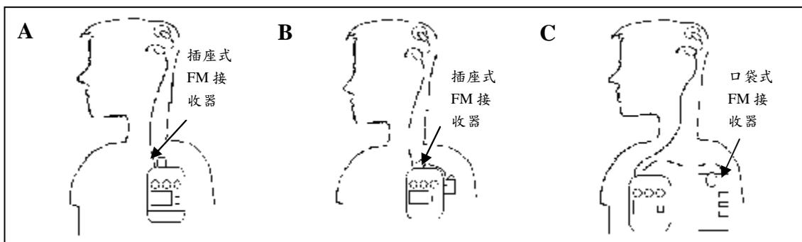
圖 5-11 口袋型電子耳蝸與接收器的連結方式：(A) (B) 無線連結（插座式接收器）；(C) 有線連結（口袋式接收器）
